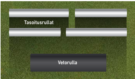
Limitetyt tasoitusrullat tekevät nurmesta ulkonäön ja pelin kannalta yhtenäisen.
