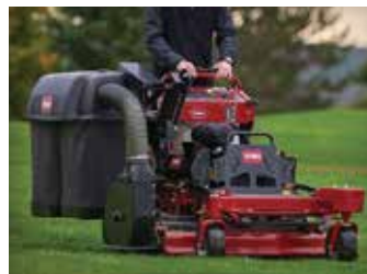
PEHMEÄ KAKSOISKE- RÄÄJÄSARJA Sivulle kiinnitettävän suuren kerääjän tilavuus on 0,28 m³. Pystysuuntaan asennettava puhallin varmistaa laitteen ohjattavuuden ja mahdollisimman hyvän näkyvyyden.
