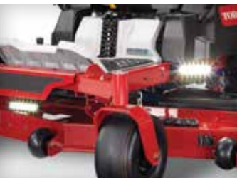
VALOSARJA Käytössä olevaan lisävarustepiiriin nopeasti kytkettävä valosarja ylläpitää tuottavuutta myös auringonlaskun jälkeen.
