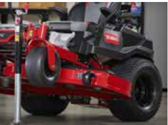
LEIKKURIN NOSTOAPU Mukavan ja ergonomisen muotoilun ansiosta paikallaan kääntyvän leikkurin leikkuupöydän alle päästään vaivattomasti. Kiinnityssarja – 140-2711 Tunkkisarja – 127-6666
