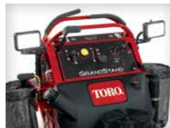
VALOSARJA Valot on helppo asentaa leikkurin runkoon, ja johdot on nopea kytkeä käytössä olevaan lisävarustepiiriin.
